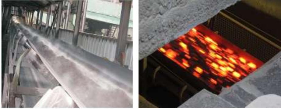
สภาพอย่างนี้ อุณหภูมิเกิน 70 องศาเซลเซียส แน่นร้อนต้องใช้สายพานทนร้อน
