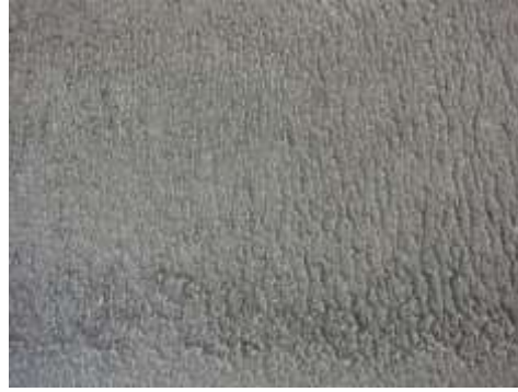
สังเกตเห็นผิวสายพานมีรอยแตกด้านขวางและแตกอย่างรูปขวามือเป็นเม็ดๆเกิดจากความร้อนแน่นอน
