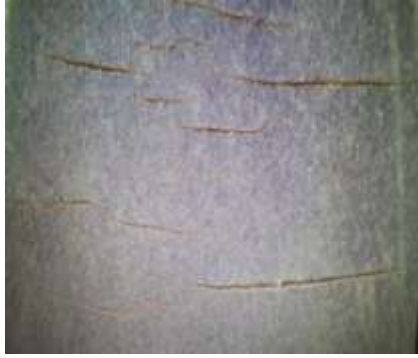
สังเกตเห็นผิวสายพานมีรอยแตกด้านขวางและแตกอย่างรูปขวามือเป็นเม็ดๆเกิดจากความร้อนแน่นอน
