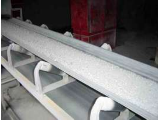
Clinker ร้อน ประมาณ 150 องศา Celsius ต้องใช้ สายพานทนร้อน
