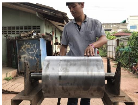
รูปแสดงการเตรียมผิวฟูเลย์ให้สะอาด ปราศจากคราบสกปรกหรือคราบน้ำมัน
