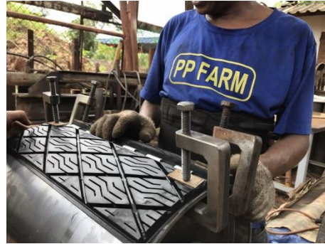
รูปแสดงการวาง Lagging pad และ Retainer ลงบนฟูลีย์
