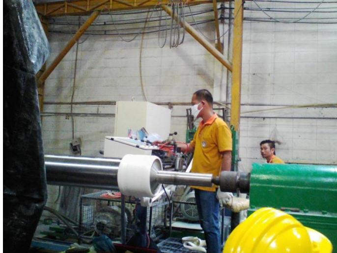
การหุ้มร้อนจะต้องมีเครื่องผสมยางและเครื่องฉีดยางและเครื่องกลึง
