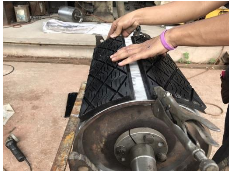
รูปแสดงการวาง Lagging pad และ Retainer ลงบนฟูลีย์
