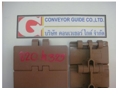
Straight-running plastic flat-top chain ปัจจุบันก็ไม่ได้ต่างจากอดีต
