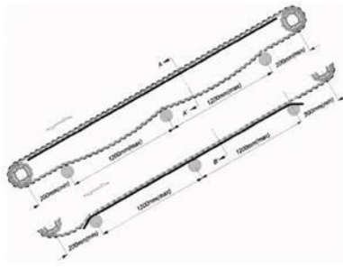
Layout ระบบสายพาน Modular แบบเอียง (Incline)
