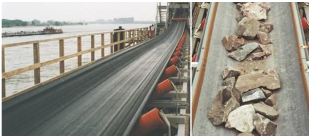
สายพาน Heavy Conveyor Belt ขณะทำงาน ลำเลียงวัสดุ
