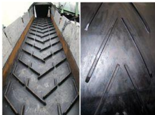
ผิวหน้าก้างปลา (Pattern Surface) มีหลายรูปแบบ
