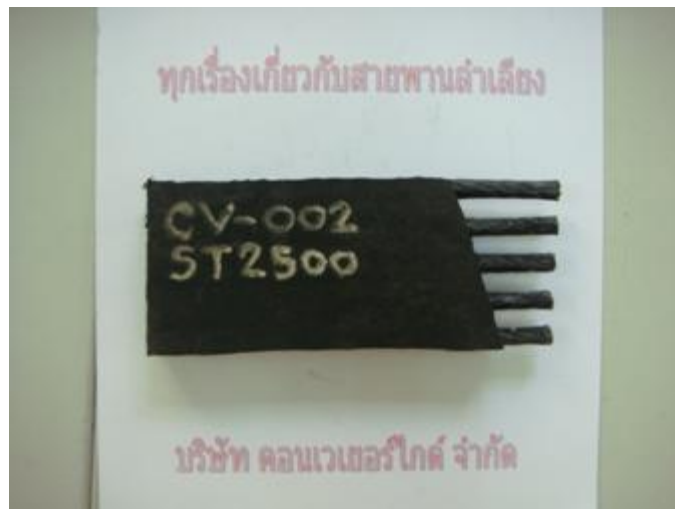
สายพานเส้นนี้คือ ST 2500 รับแรงดึงได้ 2500 N/mm.
