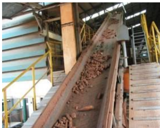
สายพานประเภทใช้งานทั่วไปผิวหน้าแบบก้างปลา
