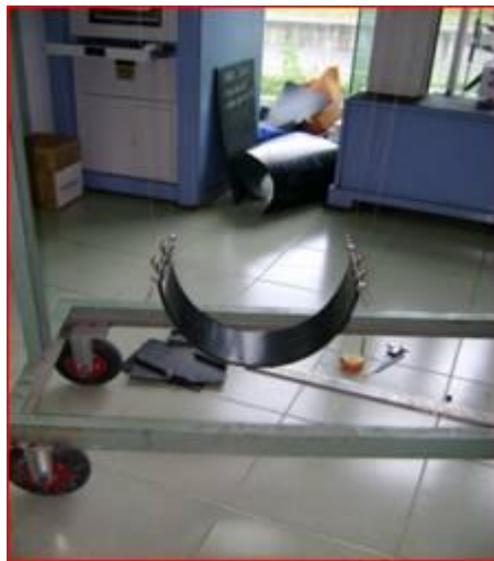
สายพานต้องห่อตัวได้ดี (Trough ability) ตามลูกกอล์ฟ
