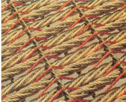
โครงสร้าง Tension Member สายพานป้องกันการขาดตามแนวยาว (Rip Resistance)
