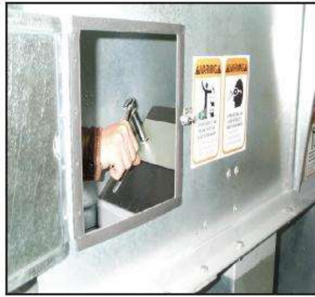
ปรับลิ้นกันวัสดุร่วง (Throat-Plate) ให้ได้ระยะที่เหมาะสม
