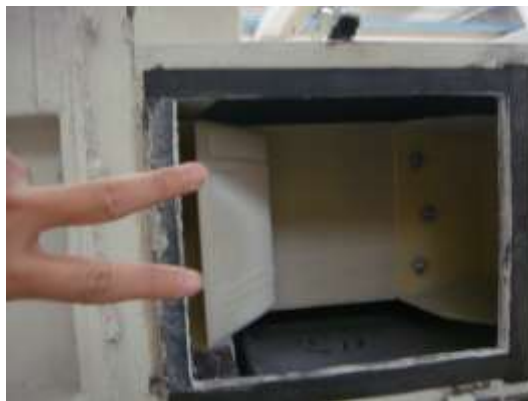
ลูกกระพ้อพลาสติก ติดกับสายพานลำเลียงด้วย Nut and Bolt
