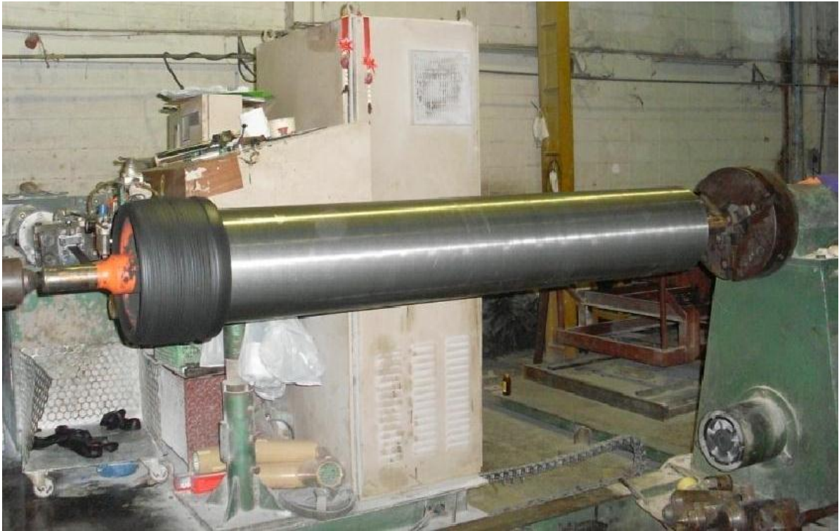
รูปตัวอย่าง การหุ้มยาง Compound แบบ ร่อง บนผิวของ Pulley
