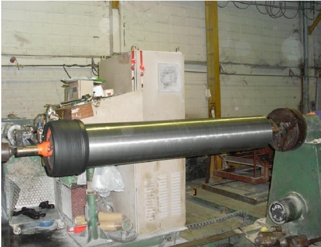
รูปตัวอย่าง การหุ้มยาง Compound แบบร้อน บนผิวของ Pulley
